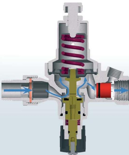
La funzione di riduzione della pressione è realizzata tramite una membrana a diretto contatto con il fluido, contrastata da una molla, che determina il movimento dell'asta solidale con l'otturatore.
